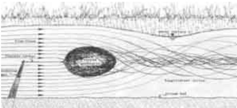
Графический продольный разрез участка русла реки, на котором видно, как с помощью простой яйцеобразной конструкции можно завихрить водные массы и смешать холодную грунтовую воду с тёплой водой поверхности, задав водам реки правильную температуру.
